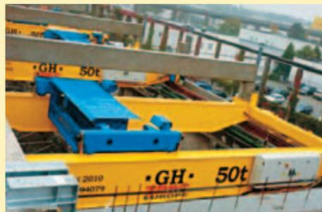
→ **BANHA**. Consisten en un puente grúa de 120/20 ton; luz 25 metros y un puente grúa de 25/5; luz 18 metros. Un pórtico de 5 ton; luz 12,5 metros. Al ser una compañía eléctrica con muchos requerimientos técnicos y con una gran complejidad de las especificaciones El apoyo de todos los departamentos de GH han sido imprescindibles.
