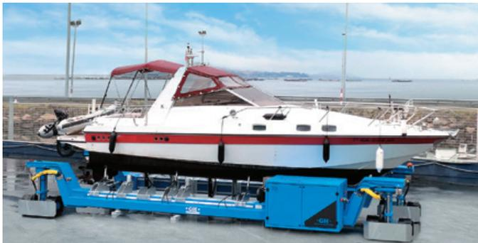
Este sistema permite uma deslocação fácil dos barcos em doca seca, tanto para tarefas de armazenamento no estaleiro naval como para inspeções e manutenções.
