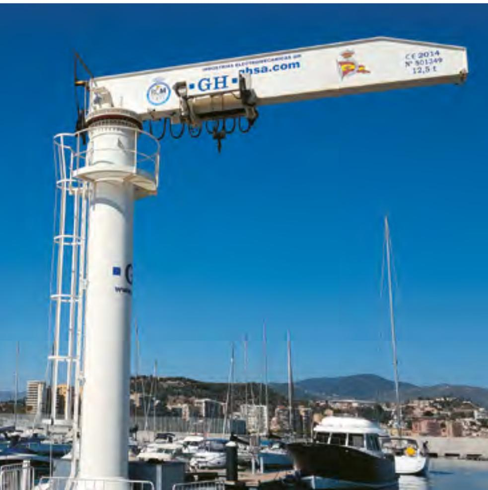
Solución ideal para el movimiento de cargas en una zona circular próxima al puesto de trabajo.
