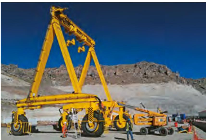
Los Pórticos Automotores **GH** sobre neumáticos permiten el movimiento de cargas en todo tipo de industrias y aplicaciones, de forma autónoma.
